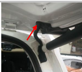
2.14 电机穿线孔: 撑杆线束已穿过原车孔位, 如图示意已安装好 ( 图片仅供参考 )
