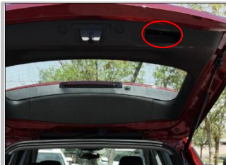
4.1 安装开关：在尾门盖板此位置安装开关按钮；
