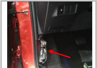
3.22 接解码器 CAN 线：在主驾驶 A 柱 CAN 线位置找到线束
