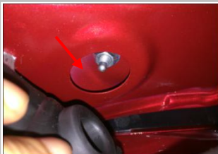
2.11 电机穿线孔: 拆下此箭头位置原车胶塞, 电机线延虚线穿过与插头对插;
