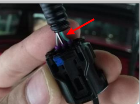
3.20 控制信号线：解码器线束控制线（灰色），接原车尾门开关插头（青色）控制信号线，
