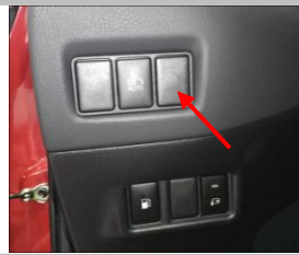
3.27 安装中控开关：拆下原车中控位置塑料件
