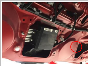
4.5 安装蜂鸣器：与 ECU 接头对接，并把蜂鸣器装在上门锁钣金内空旷处；(圆圈)
