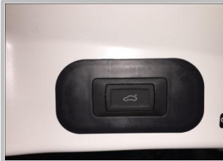
4.4 安装开关：然后把组装好的开关装原车上，线束插头对插好，如图示意已安装好
