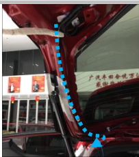
2.8 如图示意, 左电机线走向
