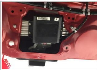
3.15 安装 ECU：用橡胶垫块（装在滑槽支架与钣金之间）配合非金属螺母 M6 把支架固定在钣金上
