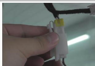
2.16 接撑杆插头端子: 对应颜色线插进凹槽内, 白色对应插槽白色, 棕色对应棕色, 把上面的黄色小卡块摘下移到下面卡紧;
