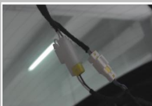
2.18 插头端子连接完成, 轻轻摇晃接头, 确定线束对接稳固;
