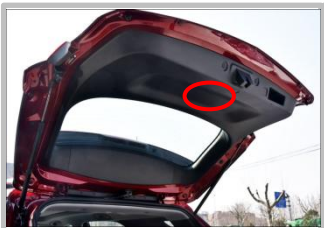
3.13 安装 ECU :ECU 安装在尾门盖板上门锁空旷处位置，
