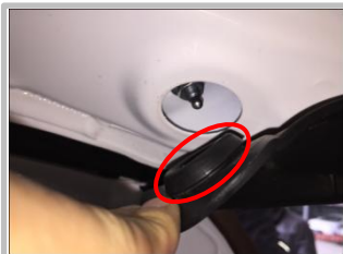
2.13 电机穿线孔: 把原车橡胶垫, 胶塞切割掉 ( 圆圈 ), 再装波纹管
