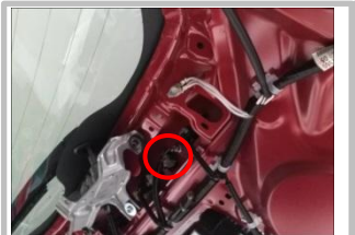
3.19 控制信号线：拆下原车尾门上盖板后，找到原车线束连接器
