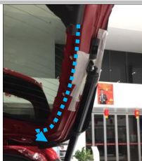
2.9 如图示意, 右电机线走向
