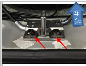
1.3 用两颗螺钉拧紧，同时把下门锁主体安装楔块 4 号、下门锁主体安装楔块 9 号安装；
