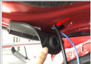
2.12 右撑杆已安装好; 提示: 用同样方法安装另一边撑杆, 电机线束; 箭头位置为右侧电机穿线孔
